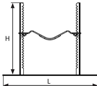
**Material Grundplatte, Pfosten und Bügel:** S 235 JR
